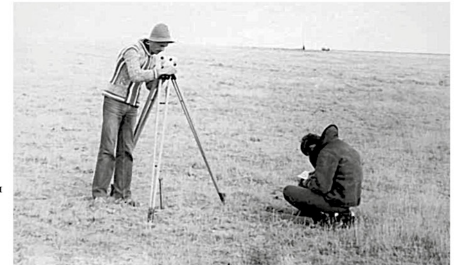
➤ Разбивка и геодезическая привязка оптических средств измерений АФА.
