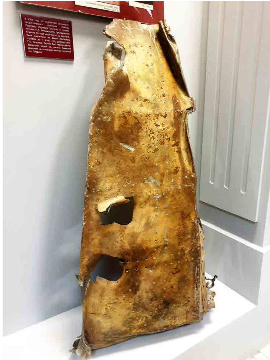
► Сохранившаяся часть разбившегося МиГ-3. Если посмотреть с внутренней стороны, то можно увидеть, что его конструкция сделана из фанеры.
